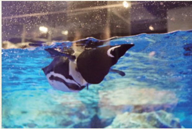
◀ペンギンロボット「もるペン!」。全長50cm。水中での前進、旋回、潜水、浮上が可能。
