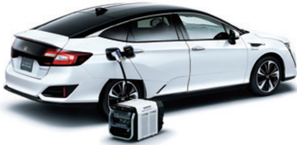
▲燃料電池自動車の電気出力口につなげて電気を取り出す「Power Exporter 9000」。
