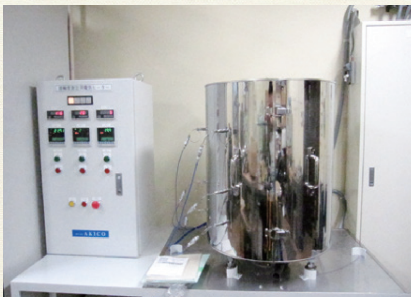
▲独自に開発した GaNの溶ける量を精密測定する装置
