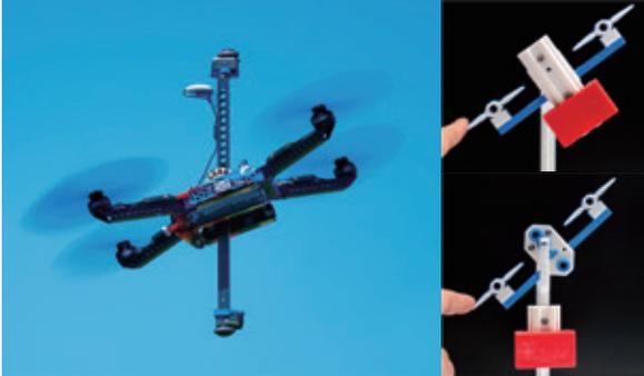
▲機体が並行を維持したまま空を飛ぶ、4D GRAVITY®システムを搭載したドローン(左)。従来型(右上)は傾くと重心が移動しますが、4D GRAVITY®(右下)は傾いても重心が変わらない。
