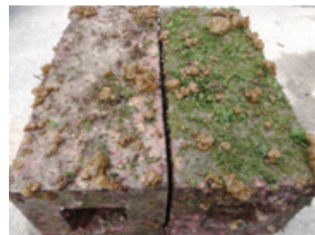
海に沈めて13か月後の環境活性コンクリート（右）。アミノ酸の入っていないもの（左）よりも、表面に多くの藻が多く生えているのがわかる。
