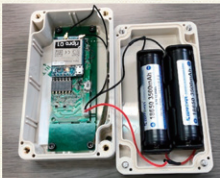
▲土壌の動きを感知できる杭上部に9軸センサーが搭載されている。
