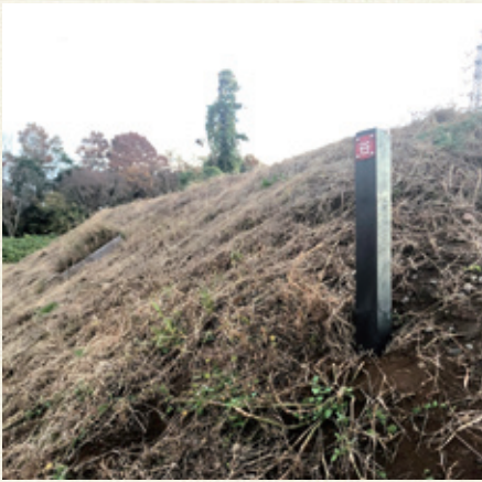
▲実際に設置されている杭は自律的に携帯ネットワークに接続する
