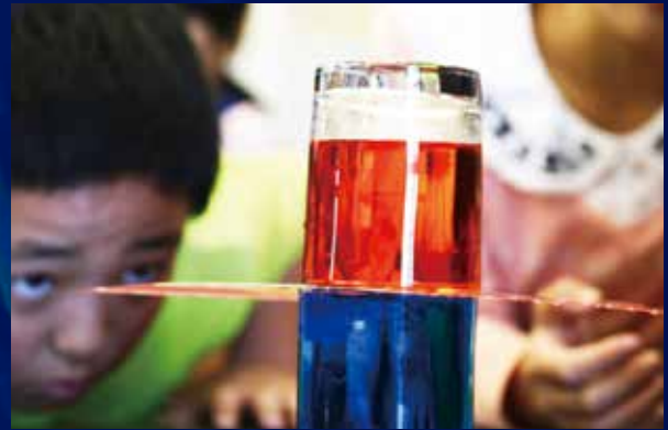
黒潮と親潮の違いを学ぶ実験の様子。二つのコップの間に挟まれた下敷きを引き抜いた際、上側の水の方が暖かければ(黒潮の場合)上下の層が維持されるが、上側の水が冷たければ(親潮の場合)上下に混ざり合う。
