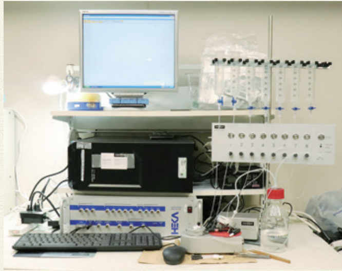
▲黒川さんが使っている薬物やイオンがどのようにイオンチャンネルに影響を与えるのかを解析する機械
