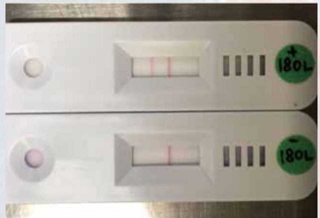
図3 開発した診断キットでの診断の様子。目的の型のウイルスがいる場合のみ、2本目のラインが現れる(写真上)。
