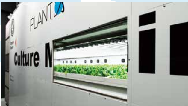
完全閉鎖型植物工場“Culture Machine”。棚ごとに密閉され、内部環境が完全に制御されている。
