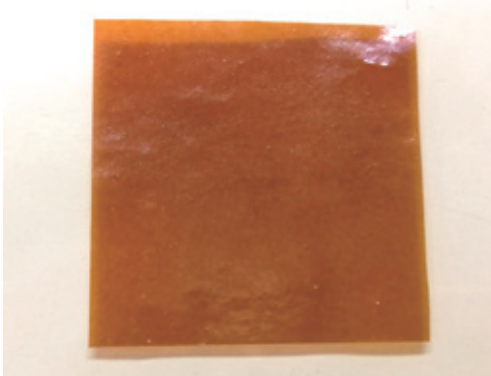
▲大西さんの研究グループが作製に成功した世界最高耐熱のPBI (Ami-PBI) (北陸先端科学技術大学院大学・金子達雄教授提供)
