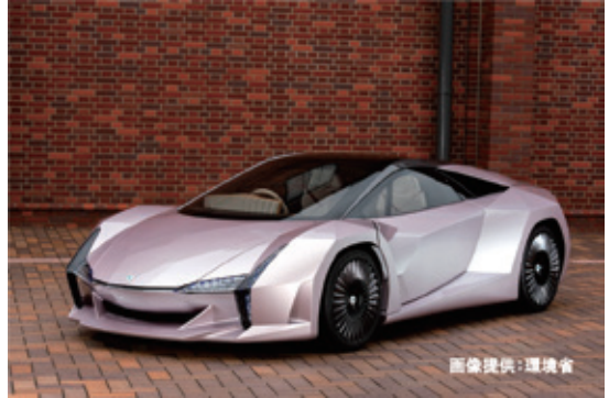
▲写真1：セルロースナノファイバーを用いたミライのクルマ「Nano Cellulose Vehicle (NCV)」
