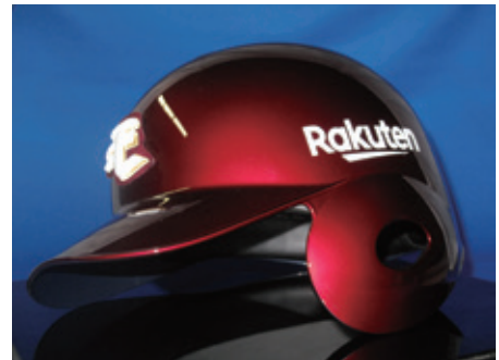
▲コーティングを施して表面のかたさが増して、紫外線による色落ちがしにくくなった野球選手用ヘルメット（産業技術総合研究所提供）
