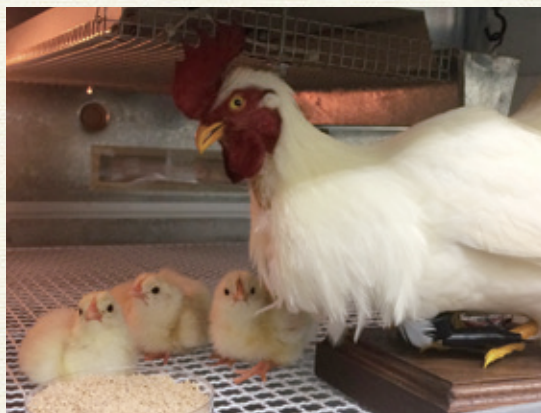
▲母鶏を模した剥製ロボット。ヒナのストレスコールを検知すると、母鶏特有の鳴き声を発する機能を搭載している。
