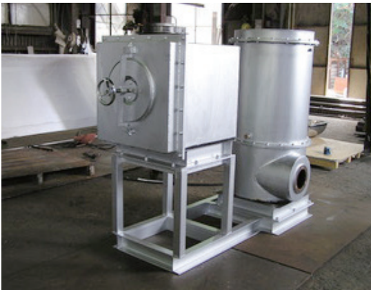
▲無酸素状態で炭素繊維を取り除く、小型した炭化炉装置
