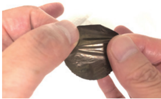
▲椎木さんが開発した、金ナノ粒子とセルロースナノファイバが結合してできた金箔。 金の5倍の強度があり、引っ張ってもなかなか破れない(右)。
