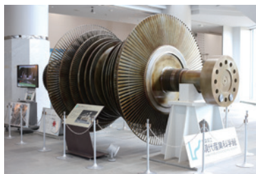
▲千葉火力発電所で使用されていた“3号タービン低圧ローター”
