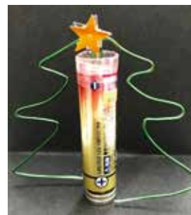
(上)ファラデーの電磁力による回転実験(1821年ごろ)と、(下)100円均一の材料で作れるファラデーモーター(参照：お茶の水大学サイエンス&エドゥケーションセンター資料)
