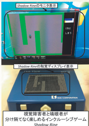
▲冒険中の主人公の位置はモニターと点図ディスプレイの両方に映し出される。
