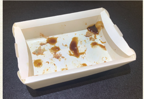
▲「MAGNATURE」でつくった、たこ焼きの容器。 「紙」なのに、ソースの水分や油分も通さない！
