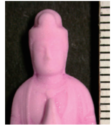
▲図3 フラックスコーティング法を用いて作製した仏像
