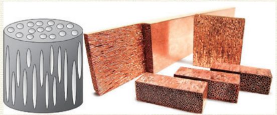
▲ロータス金属の構造の模式図（左）と、ロータス銅の実物写真（右）。均一で細かい穴が開いていることがわかる。
