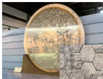
▲ケーブルの断面図とその拡大図
