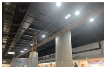
▲明石海峡大橋の1/100サイズの模型。 風などの影響を調べるための研究所での 試験で、実際に利用された。
