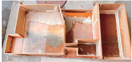
▲作成したモデル実験水槽
