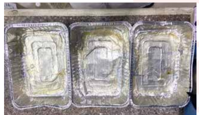
アルギン酸塩の含有量(10g、9g、8g)を変化させて作成したフィルム
