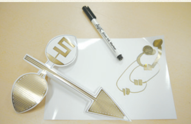
▲回路の印刷技術を使って川原さんが開発した土壌の水分量を測定するセンサ。
