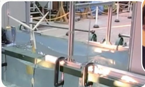
▲新日鉄住金エンジニアリング(株)の大久保寛さん。風・波浪下における浮体式風車の動揺実験(左)や海洋工事(右)を通じて、海と対峙している。
