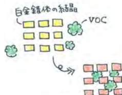
◀ VOC ガスが白金錯体の分子の隙間に入り込むと、紫外線照射下で赤く発光する。
