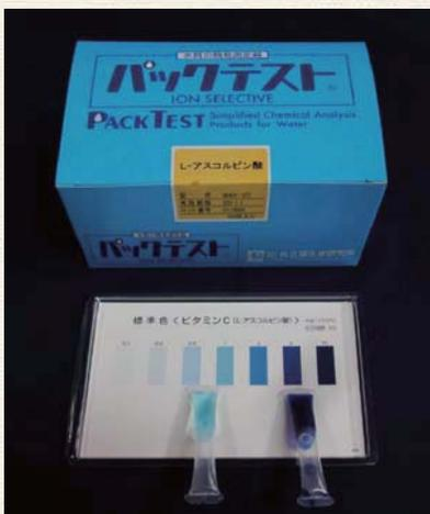
実験で使用したのは、このキット。測定用チューブ先端のラインを引き抜き、穴を上にして指でチューブ内の空気を追い出します。そのままの状態、スポイトを使う容量で測定する液体を取り込み、5～6分振りまぜてから3分後に測定。標準色と比較して、一番近い青色の値を、その液体の測定値とします。
