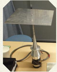
▲ 空気中に超音波を発生させる装置。
