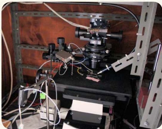
▲ カスタマイズされた顕微鏡。 視細胞をこれで観察しながら電気応答を測定する。
